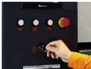
Mistä tahansa ryhmän pilarista voi tehdä ohjaus- pilarin NFC-lähitunnisteellä
